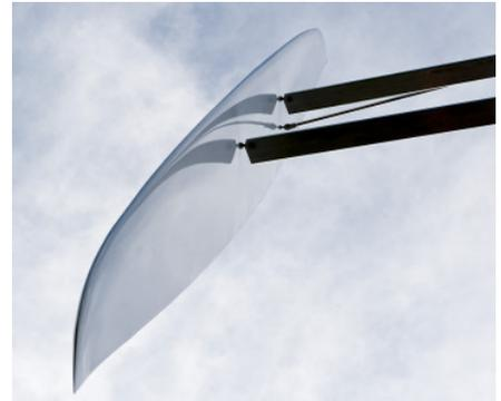
**Akustisch:** Die bisherigen, horizontalen Windanlagen weisen erhebliche Lärmemissionen auf, welche durch die radialen Flügelgeschwindigkeits-Differenzen hervorgerufen werden. Bei der neu angewandten, vertikalen Technologie, strömt der Wind über die ganze Flügelspannweite mit konstanter Geschwindigkeit. Dies verursacht selbst unter Vollast (140 km/h) keine, bzw. vernachlässigbare Lärmemissionen.
