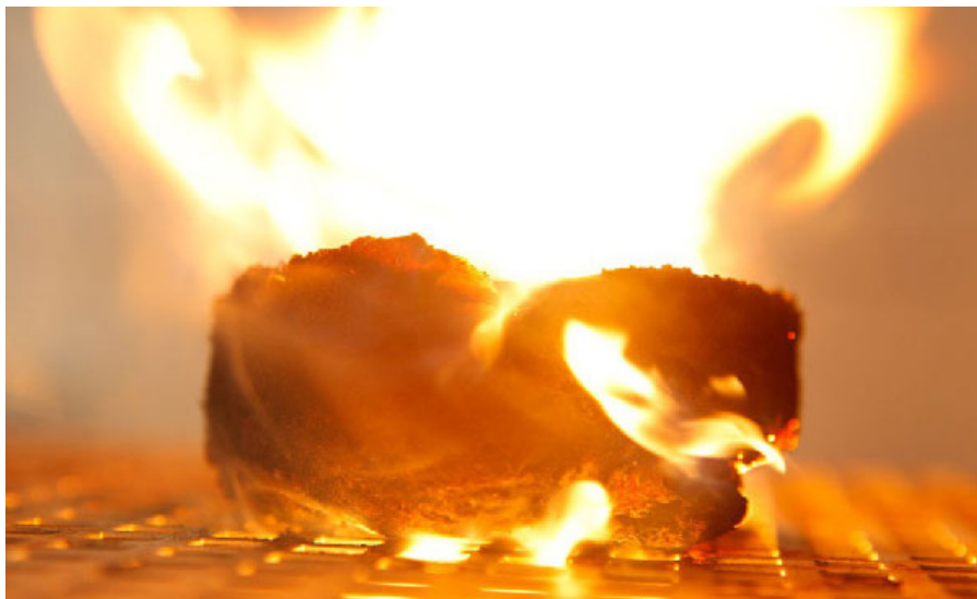
Hydrokohle verbrennt mit sehr sauberer Flamme und sorgt für niedrige Abgasbelastung
