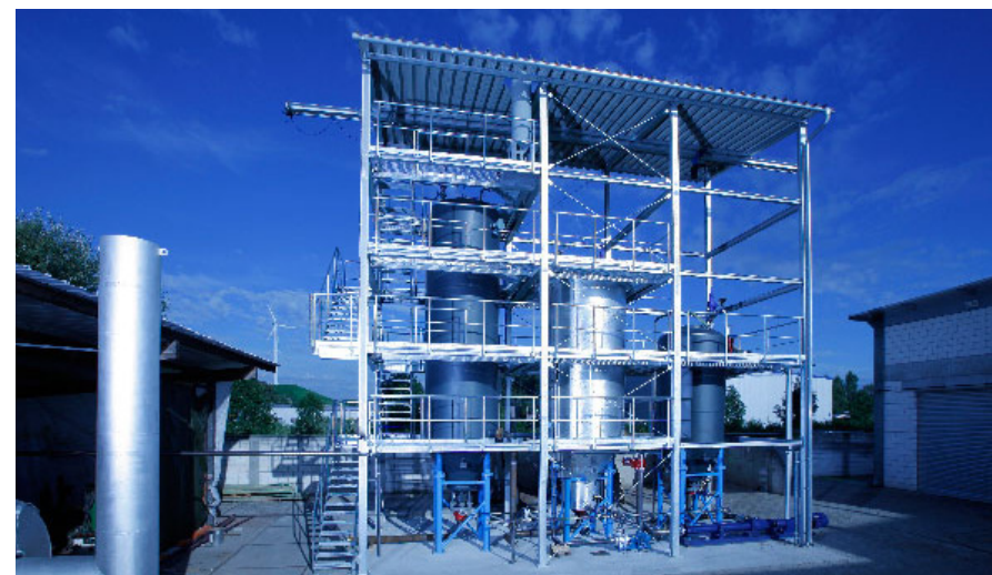
Die weltweit erste industrielle HTC-Anlage der Firma AVA-CO 2 mit einer Jahreskapazität von 8400 t Biomasse
