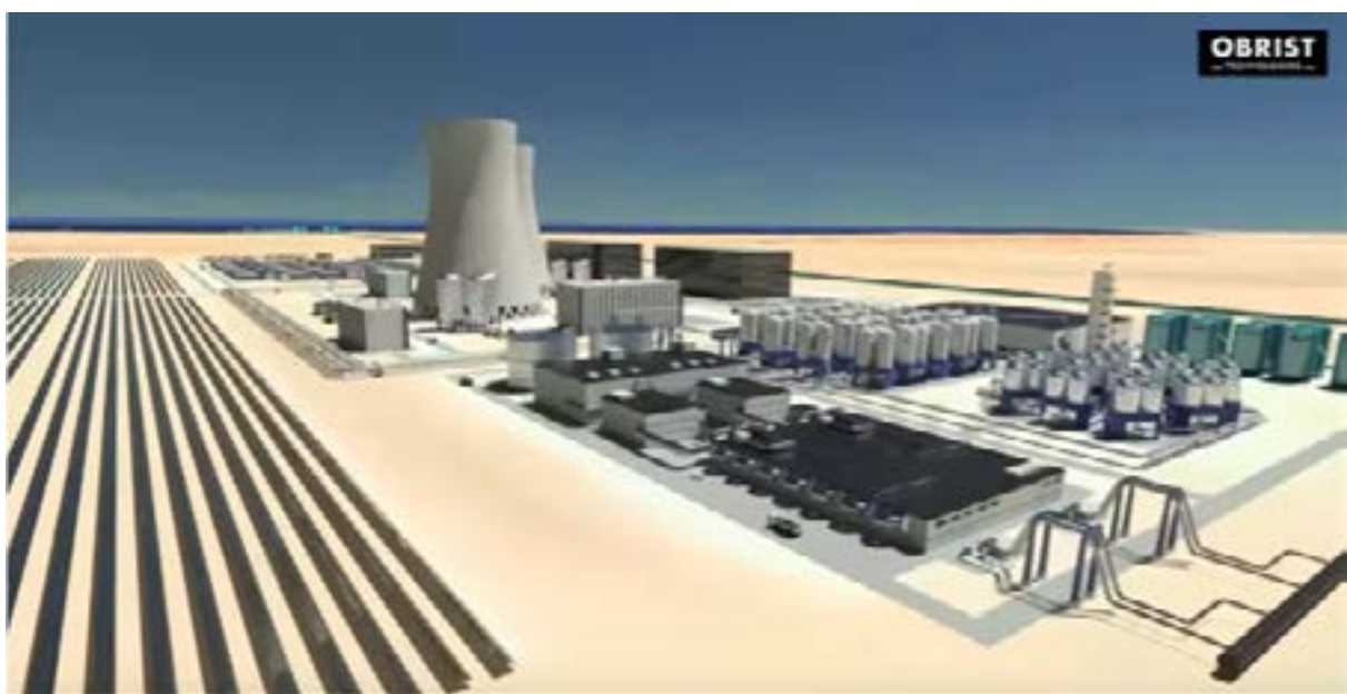
Abbildung 3: Modell einer Anlage, die mittels Solarenergie CO 2 aus der Atmosphäre gewinnt und mit elektrolytisch aus entsalztem Meerwasser gewonnenen Wasserstoff zu Methan synthetisiert. Methan ist der grundlegende Rohstoff der Chemieindustrie sowie Ausgangsstoff für weitere Treibstoffe und künstliche Biochar. (Quelle: Obrist AG ).
